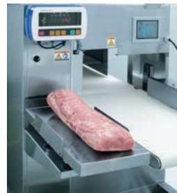
材料の重量測定完了後、肉送りベルトに載せ替えてスタートスイッチを押すだけ。
