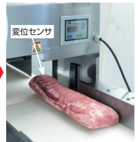
材料の形状を上下2個ずつの変位センサにより読み込み、自動でスライス開始。
