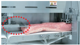
丸刃偏芯軌道 丸刃に取付穴が3箇所あり、取付位置が変更できます。
