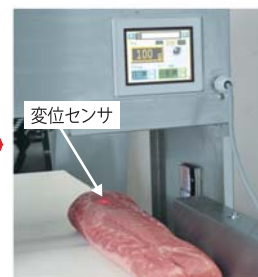
変位センサにより材料の形状を上下2個ずつの変位センサにより読み込み、自動でスライス開始。
