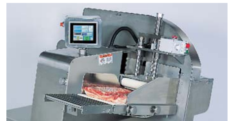
最適な肉押え・肉送りを実現するエアシリンダー
