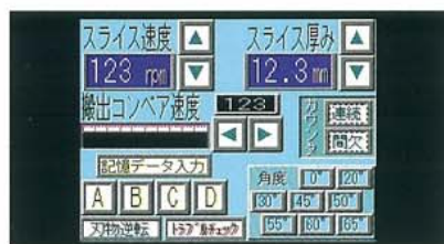
作業状況やデータの照会・機械の状況チェックが一目で把握できるカラータッチパネル。
